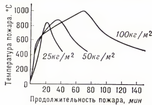
Рис. 3. Температурный режим пожара при различной горючей нагрузке древесины.
